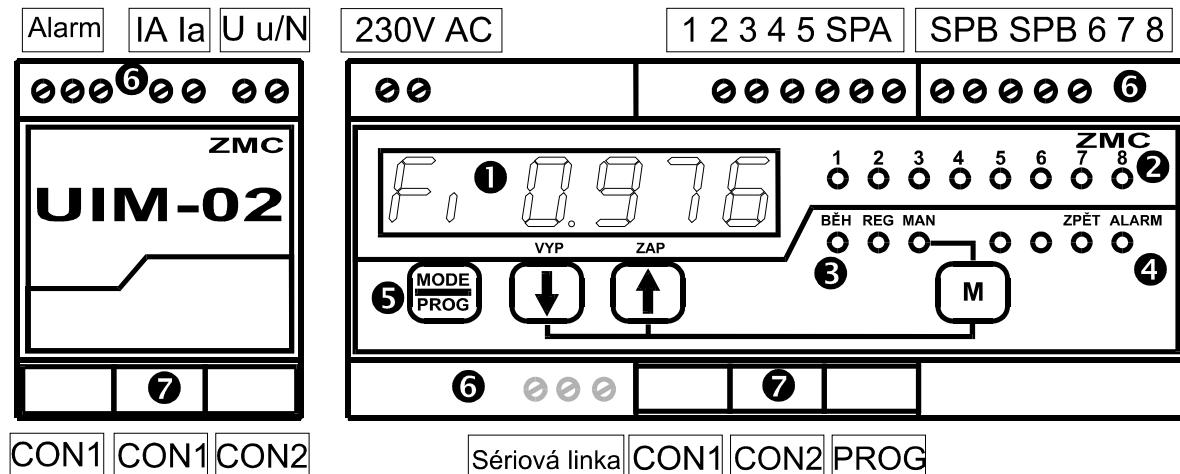
Display: ① Přístroj je osazen 6-ti místným displayem ze sedmisegmentových LED zobrazovačů. První dva znaky jsou zelené a znázorňují zkratku zobrazovaného či programovaného parametru, popř. hlášení. Zbylé čtyři znaky jsou červené a zobrazují hodnotu parametru, popř. význam hlášení.
